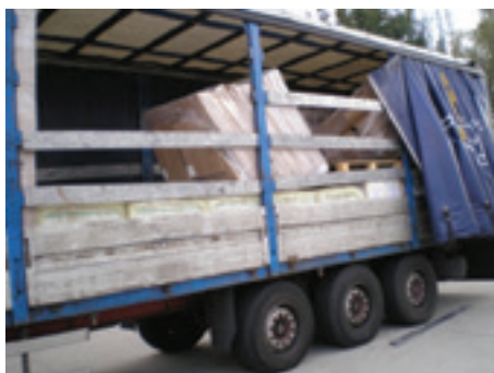
Figura 19: insufficiente fissazione del carico solo con film estensibile
