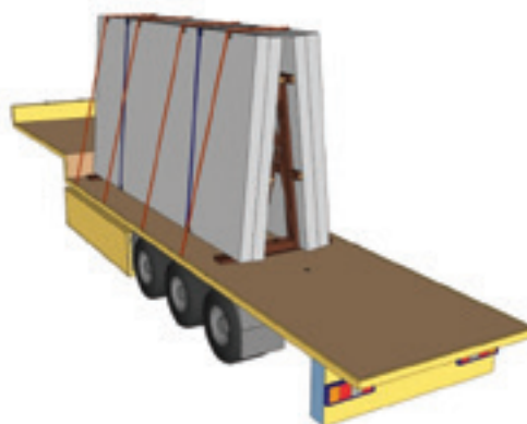
Figura 48: fissazione con combinazione tra bloccaggio, struttura ad A, ancoraggio rotondo e ancoraggio per attrito
