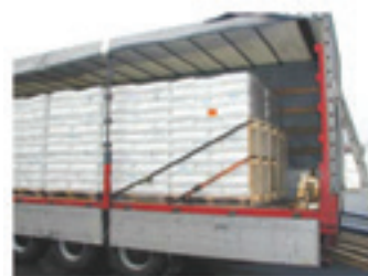
Figura 39: ancoraggio antirimbalzo tramite pallet
