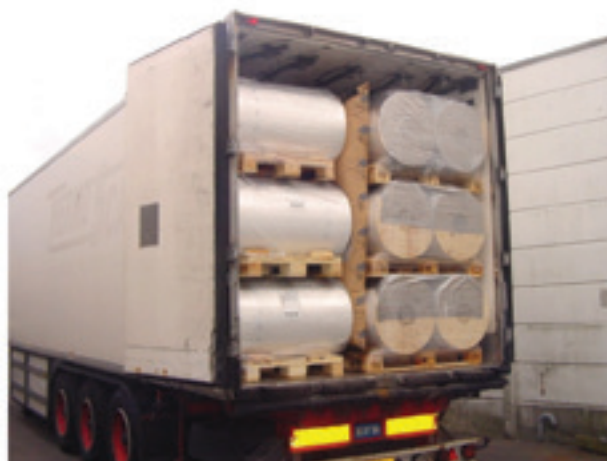
Figura 28: riempitivo tra file di carico
