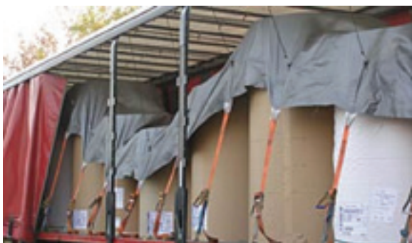
Figura 31:fissazione con copertura
