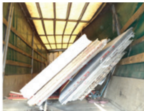
Figura 45: struttura ad A caduta
