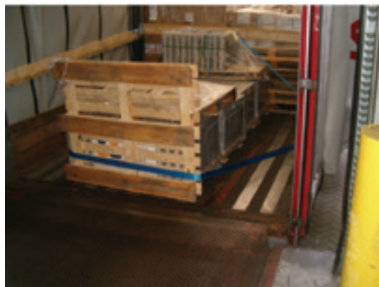
Figura 75: sistema di fissazione sul retro per carico misto
