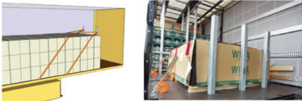
Figura 7: montanti utilizzati per il bloccaggio in avanti
