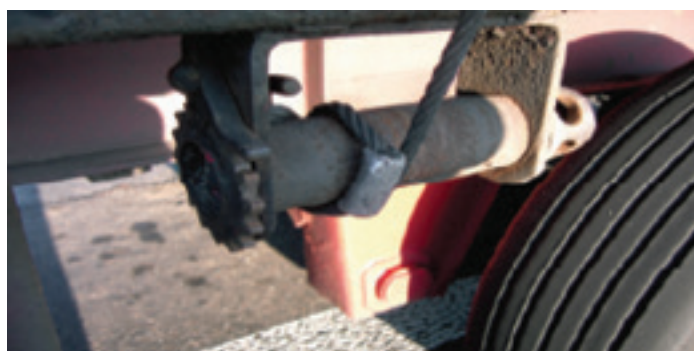
Figura 24: fune di acciaio messa in tensione da un verricello
