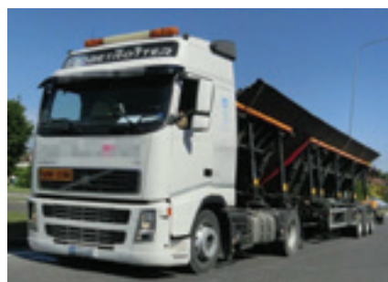
Figura 14: lastre di acciaio trasportate con un'inclinazione di 45°
