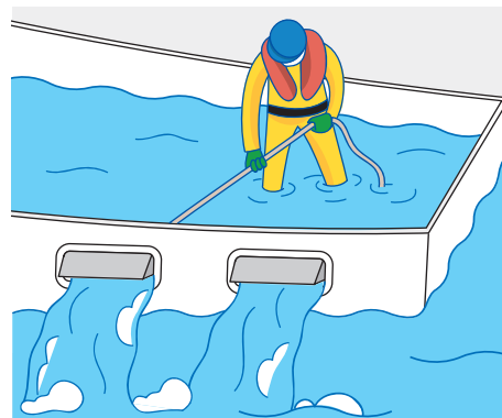
VI-7. L'acqua presente sul ponte scorre creando l'effetto di superficie libera (adattamento da Transport Canada, 03/2003)
