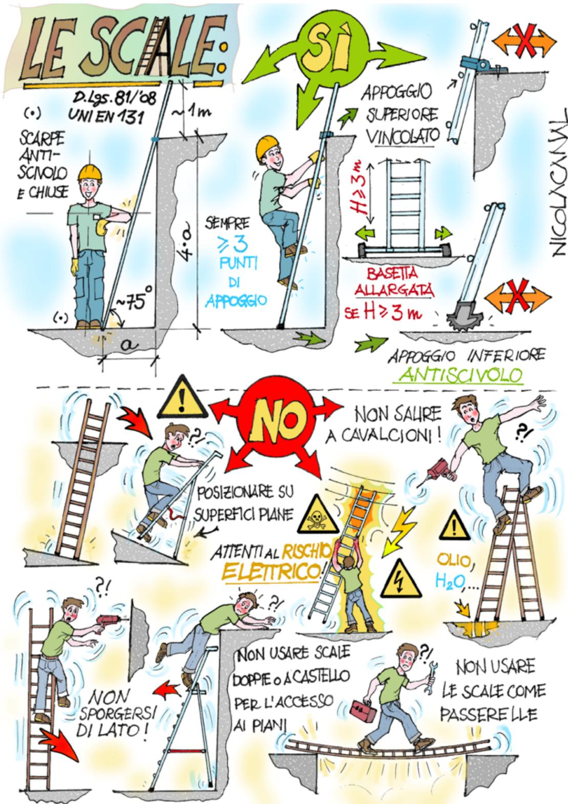
Le scale semplici portatili sono attrezzature molto utilizzate negli ambienti di vita e di lavoro. L'uso scorretto della scala, oppure la scelta di una scala non adeguata al tipo di ambiente o di lavorazione sono alla base dei non pochi incidenti, non esclusivamente professionali. Una scala portatile deve rispondere alla norma tecnica UNI EN 131 ed essere corredata dalle certificazioni previste emesse da un laboratorio ufficiale e dal manuale di uso e manutenzione.
