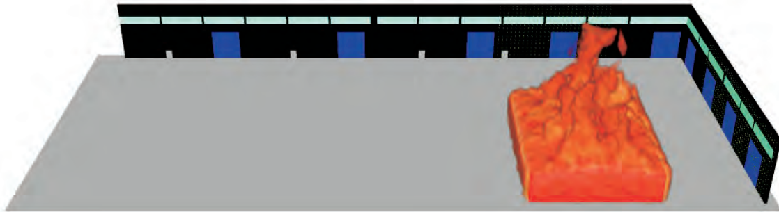
INCENDIO NEL DEPOSITO - IRRAGGIAMENTO VS REPARTO PRODUTTIVO - METODO DELLE FIAMME VISTA DELLE FIAMME PRODOTTE DALL'INCENDIO
