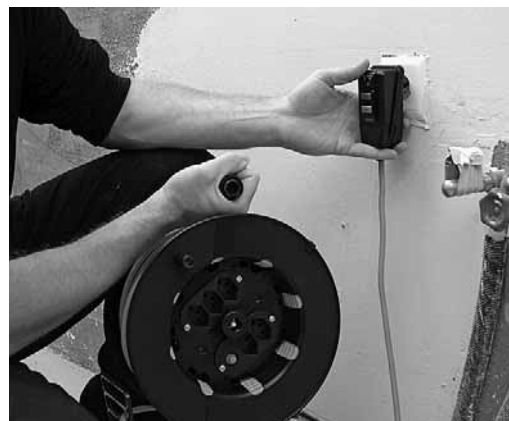
Fig. 4: bobina di cavo con interruttore FI.
