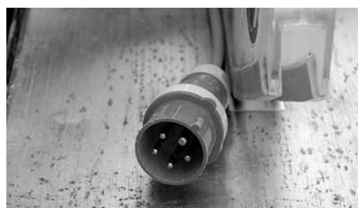
Fig. 2: le nuove spine trifase (CEE) sono di colore rosso, forma rotonda e a 5 poli.
